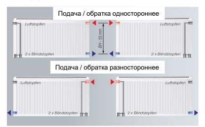
Монтажный комплект для компактного подключения (боковое подключение)
