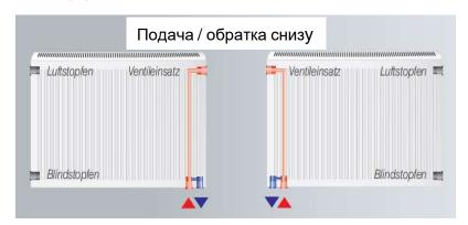
Монтажный комплект для вентильного подключения (нижнее подключение)
